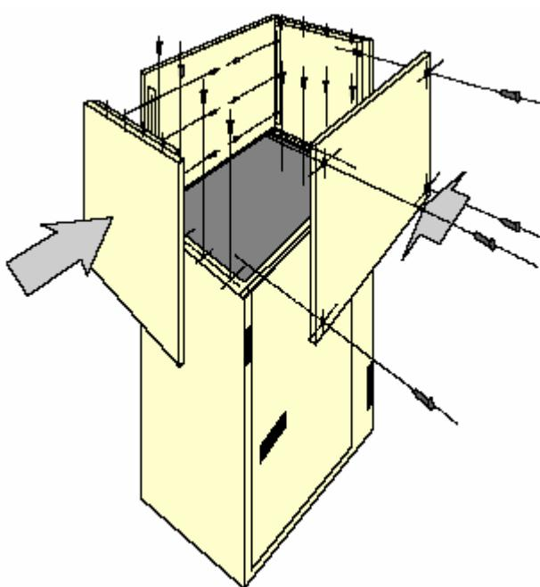
Рис. 8. Кондиционер с верхним выдувом и электрическими нагревателями
