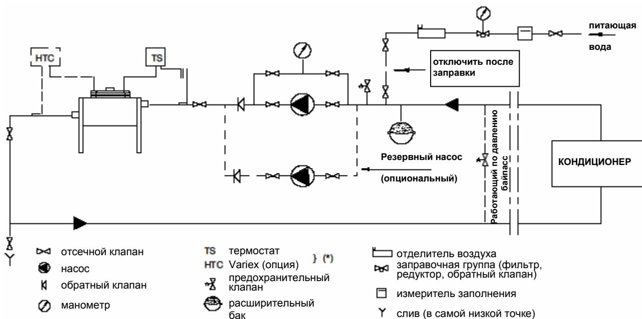
См. схемы гидравлических соединений в Приложении D.
