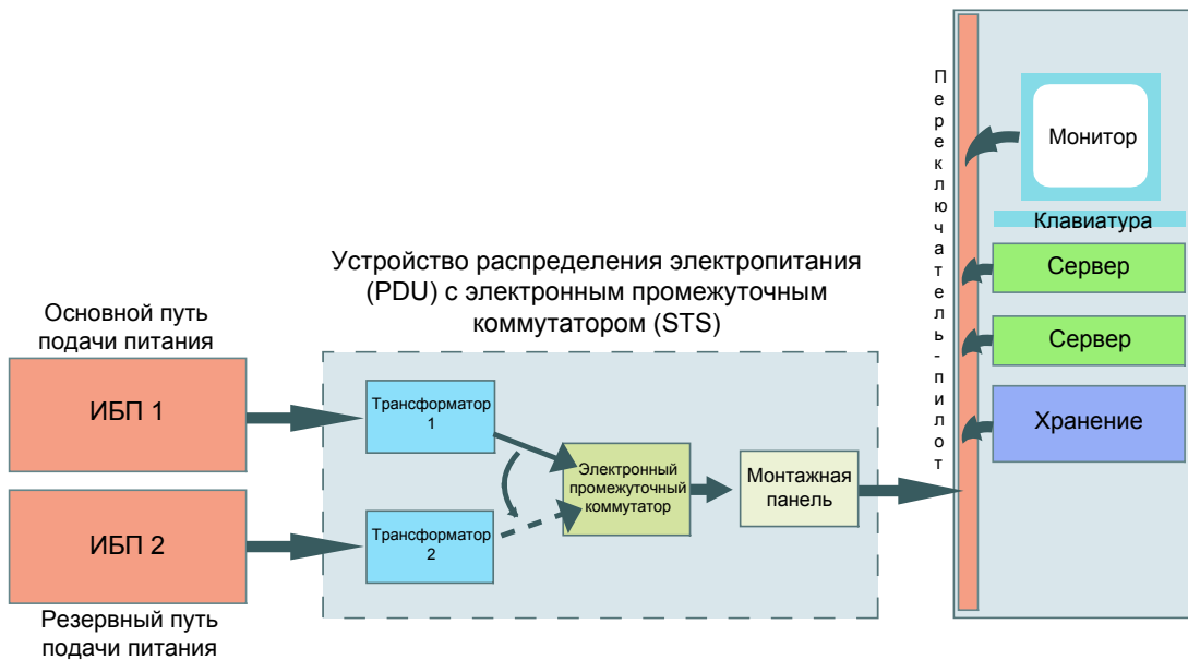
Рис. 4. Избыточность для нагрузки с STS (резервные трансформаторы)
